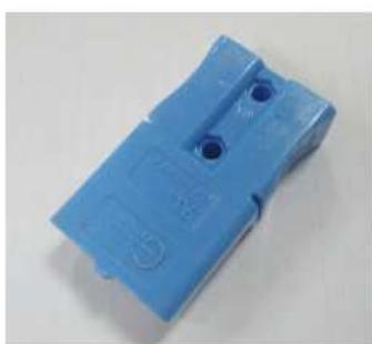
Basés sur la conception hermaphrodite mise au point par Anderson en 1953, les connecteurs GPS40 AFP permettent le passage de 45A dans un boîtier ultra-compact. Les connecteurs GPS40 AFP sont dotés d'un boîtier en plastique monobloc utilisant des ressorts en acier inoxydable pour maintenir en place les contacts à faible résistance allant de # 20 (0.5 mm<sup>2</sup>) à # 8 (8,3 mm<sup>2</sup>).
