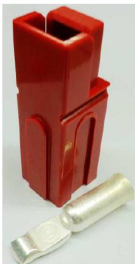
La série SPC 180 peut être utilisée pour des applications « contact à contact » ou busbar. Toute la gamme est compatible avec les produits ANDERSON et REMA équivalents. Les contacts utilisés vont de AWG 6 (16 mm<sup>2</sup>) à AWG 3/0 (95mm<sup>2</sup>) et offrent une puissance pouvant aller jusqu'à 300 ampères par pôle en fonction du contact utilisé.
