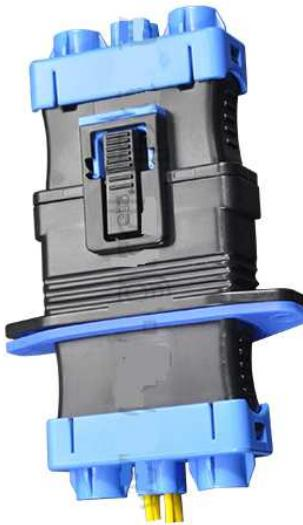
Les connecteurs bipolaires PSF90 sont composés de deux contacts de puissance et peuvent être équipés de 4 signaux dans un boîtier très compact. Les connecteurs PSF90 sont dotés d'un boîtier en plastique monobloc utilisant des ressorts en acier inoxydable pour maintenir en place des contacts à faible résistance allant de # 10 (5.3 mm<sup>2</sup>) à # 6 (13,3 mm<sup>2</sup>) et des contacts auxiliaires de # 20/18 (0.75/1.0 mm<sup>2</sup>).
